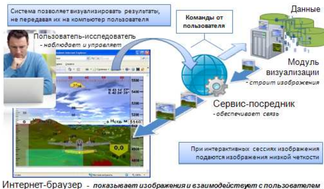
Рис. 1. Общая схема системы онлайн-визуализации
