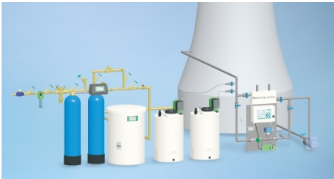
Пример системы подготовки охлаждающей воды
