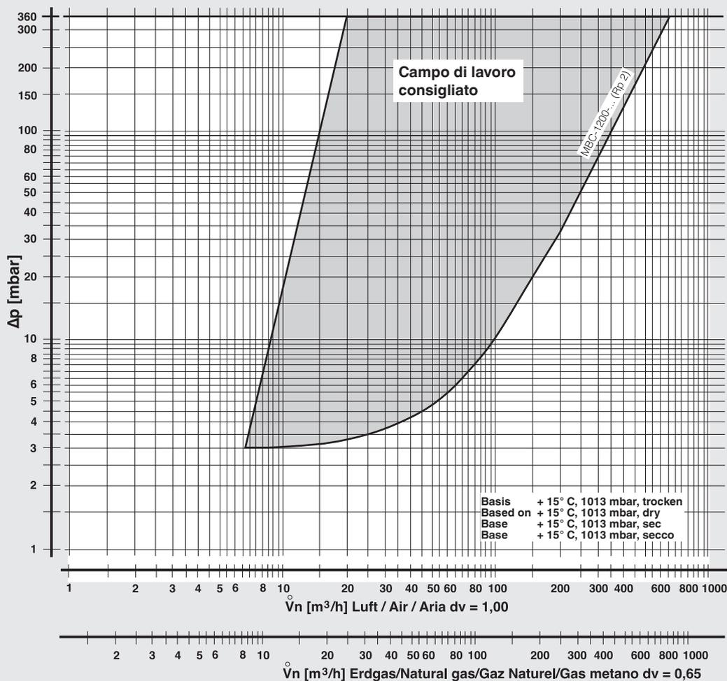
$$f = \sqrt{\frac{\text{peso specifico aria}}{\text{peso specifico gas utilizzato}}}$$
