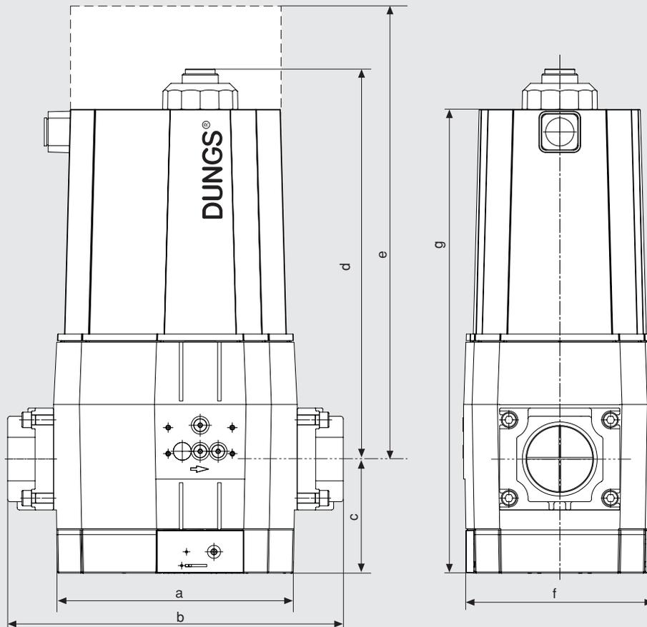
e = spazio necessario per la sostituzione della bobina
