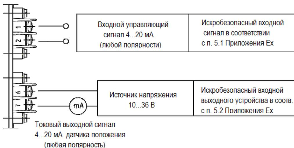
Рис. 21. Электрические подключения позиционера APIS-XX0-....
