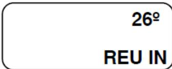
Нажать 1 раз клавишу **▼**, тогда на дисплее появится текущая температура окружающей среды и символ функции установки реверса выходного сигнала (датчика положения).
