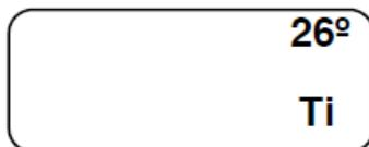
Нажмите 1 раз клавишу ▼, на дисплее появится текущая температура окружающей среды и символ функции установки постоянной времени в [сек.] дифференцирующего звена PID регулятора
