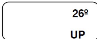
Нажмите 1 раз клавишу ▼, на дисплее появится текущая температура окружающей среды и символ функции, обеспечивающей ручное управление
