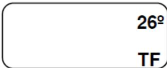
Нажмите 1 раз клавишу ▼, на индикаторе появится текущая температура окружающей среды и символ функции автоматической настройки и нормализации хода штока привода
