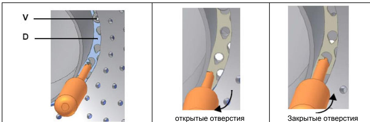
Регулировать положение головы сгорания только в случае необходимости: для работы на сниженной мощности расслабить винт VB и постепенно сдвигать голову сгорания в сторону положения "MIN", вращая по часовой стрелке регулировочное кольцо VRT. Заблокировать винт VB при завершении регулировк.
