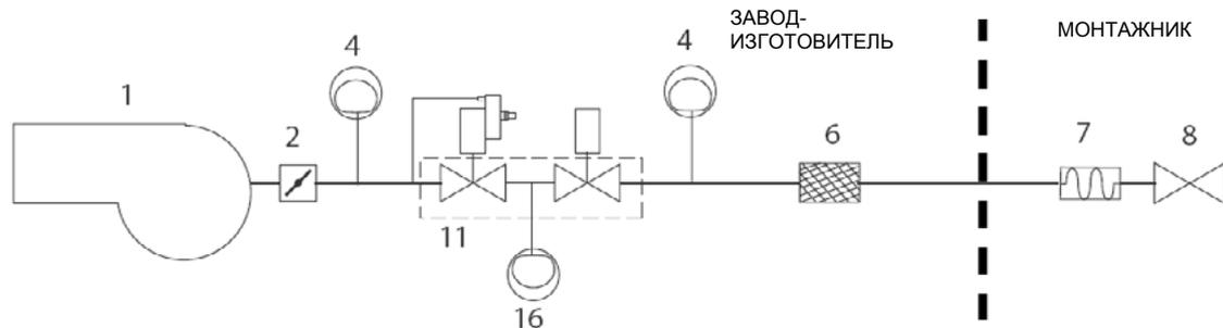
Газовая рампа с группой клапанов MBC 1200 SE (2 клапана + газовый фильтр + стабилизатор давления + реле давления) + реле давления газа для контроля за утечками PGCP
