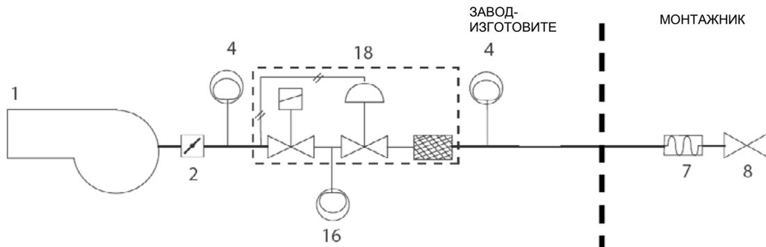
Газовая рампа с группой клапанов MBC 1900/3100/5000SE (2 клапана + газовый фильтр + стабилизатор давления + реле давления) + реле давления газа для контроля за утечками PGCP
