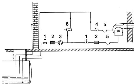
**- Контур подачи топлива всасыванием**
