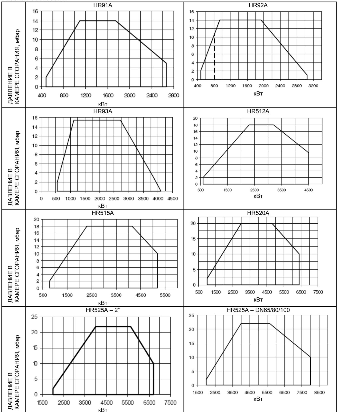
Чтобы получить мощность в ккал/ч, умножьте значение в кВт на 860. Эти данные относятся к стандартным условиям: при атмосферном давлении в 1013 мбар и температуре окружающей среды в 15°C.
