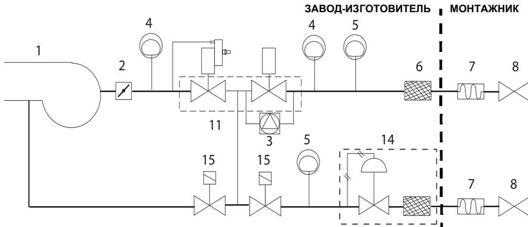
Газовая рампa 3 (DN65/80/100): Газовая рампa с группой клапанов MBC SE 1900/3100/5000 (2 клапана + газовый фильтр + стабилизатор давления) + блок контроля герметичности VPS504 и рампa запальной горелки
