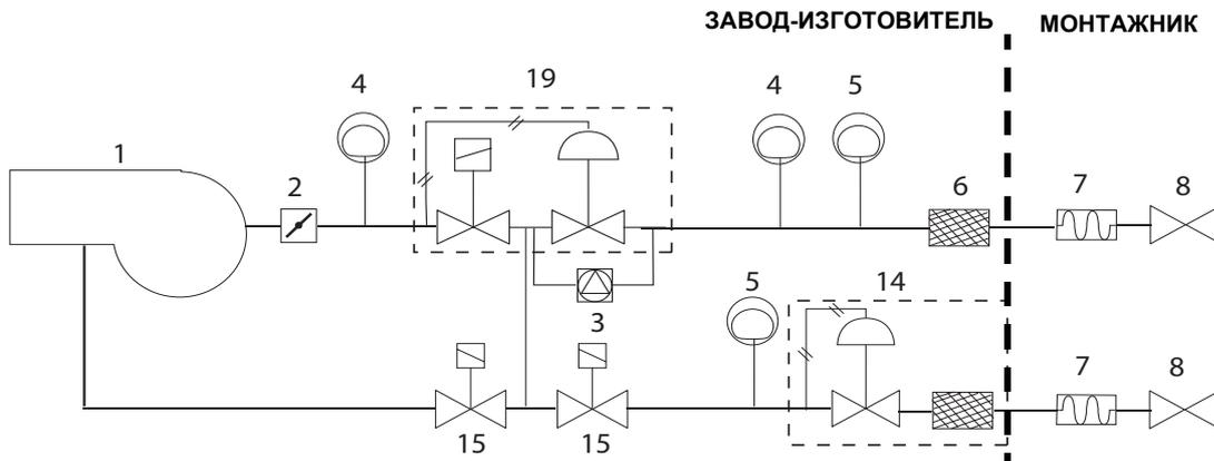
Газовая рампа 3 (DN125): Газовая рампа с группой клапанов VGD40 (2 клапана + газовый фильтр + стабилизатор давления) + Реле давления газа для контроля за утечками и рампа запальной горелки (PGCP)+Рампа запальной горелки
