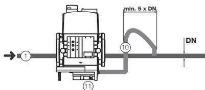
10 = импульсная трубка
