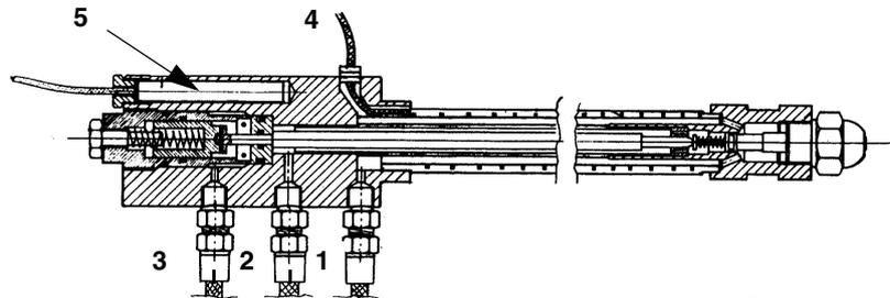
**Распределительный блок на горелке**
