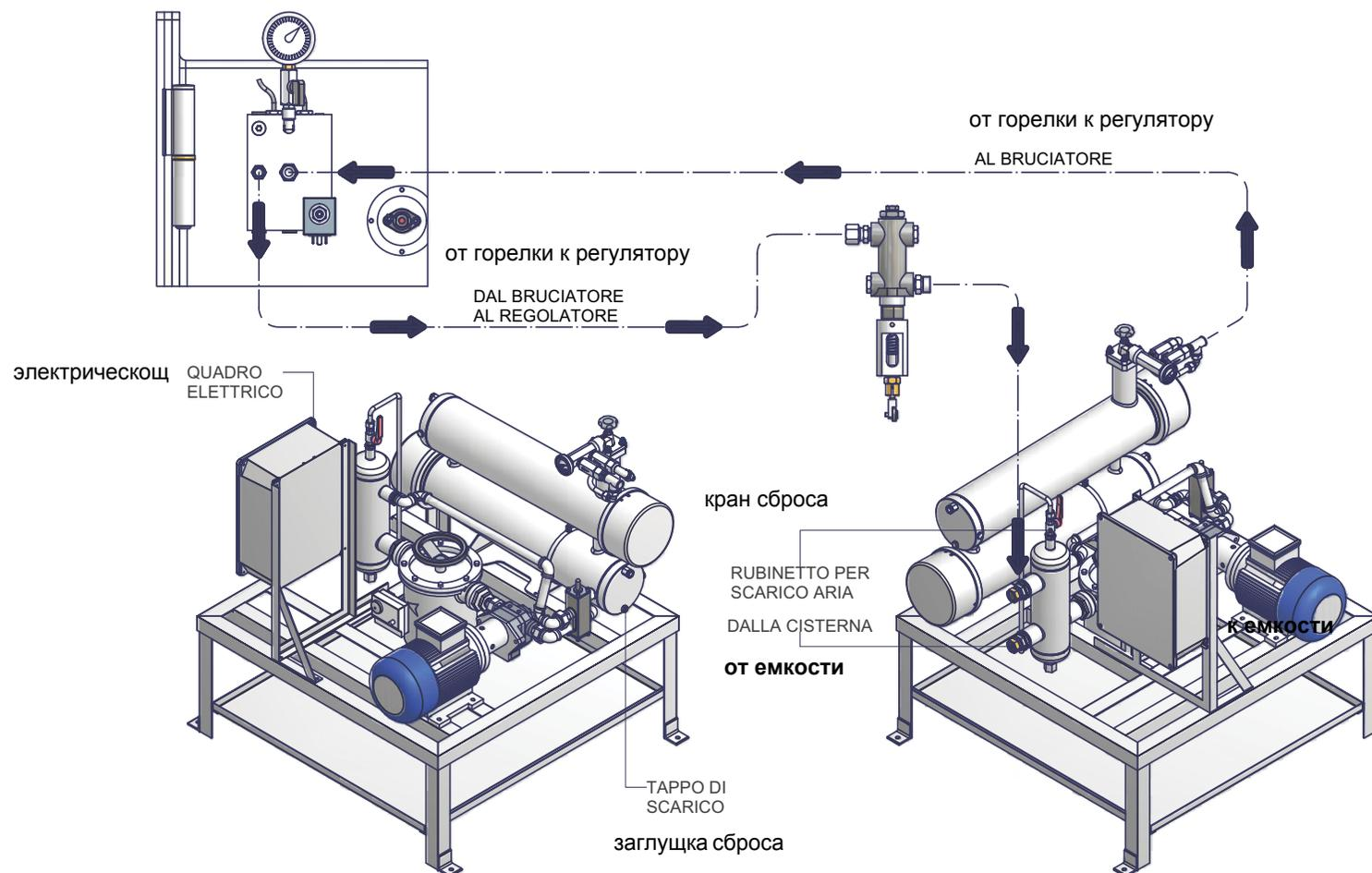
**ВНИМАНИЕ:** пластмассовые заглушки не герметичны и служат только в целях транспортировки. Шланги, подсоединяемые между насосом и горелкой, это шланги, обозначенные на этикетке, как "Шланги для жидкого топлива высокого давления". Шланг, обозначенный на этикетке, как " Шланг для жидкого топлива низкого давления", подсоединяется перед фильтром.
