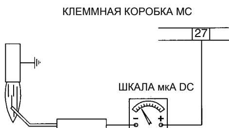
Рис. 30 - Контроль пламени с помощью электрода
