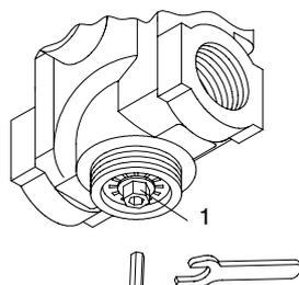
**Клапан регулирования давления Brahma EG12\*R**
