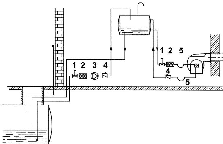
Рис. 12- - Кольцевой контур подачи топлива
