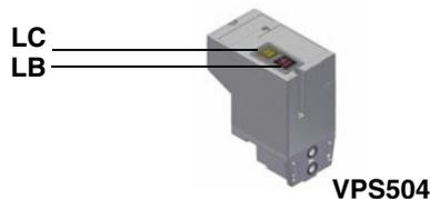
**Н.В.:** В случае горелок, оснащенных блоком контроля герметичности Dungs VPS504, фаза предварительной вентиляции начинается только после завершения контроля герметичности газовых клапанов с положительным результатом.
