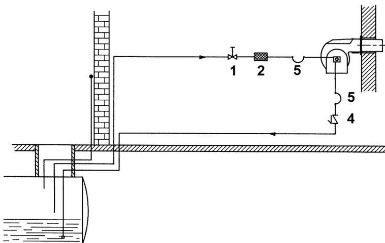
ПРИМЕЧАНИЕ в системах с гравитационной подачей или с кольцевым контуром, установить автоматическое отсечное устройство (см. № 4 - Рис. 14).
