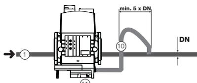
10 = импульсная трубка
