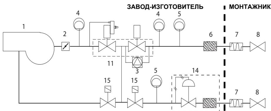
Газовая рампа 2 (DN80/100): Газовая рампа с группой клапанов MBC SE 1900/3100/5000(2 клапана + газовый фильтр + стабилизатор давления) + блок контроля герметичности VPS504 и рампа запальной горелки
