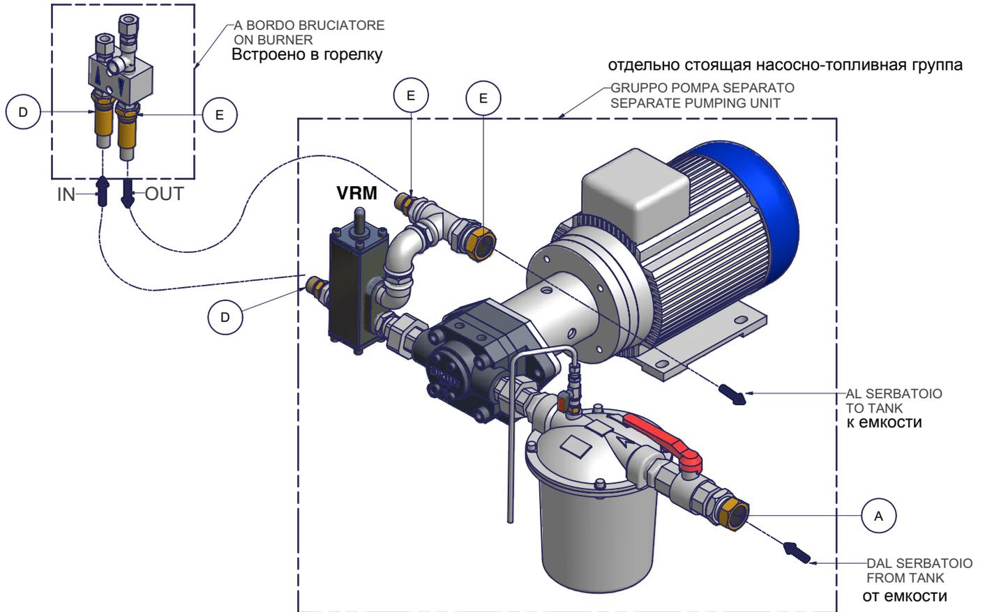
**ВНИМАНИЕ:** пластмассовые заглушки не герметичны и служат только в целях транспортировки. Шланги, подсоединяемые между насосом и горелкой, это шланги, обозначенные на этикетке, как "Шланги для жидкого топлива высокого давления". Шланг, обозначенный на этикетке, как " Шланг для жидкого топлива низкого давления", подсоединяется перед фильтром.
