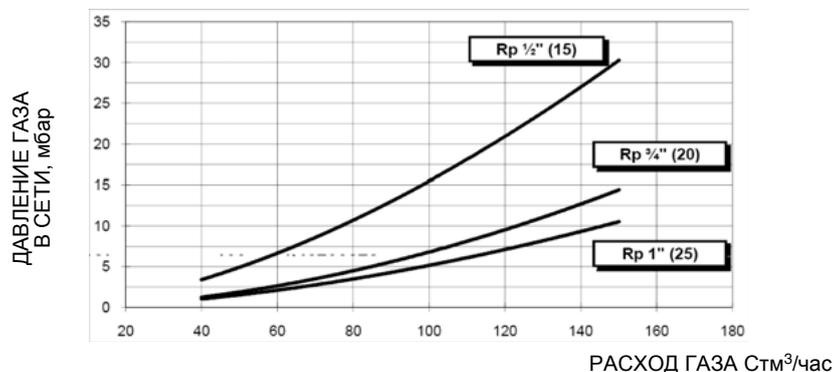
**Внимание:** на абсциссе указывается значение расхода газа, на ординате - соответствующее значение давления в сети без учета давления в камере сгорания. Чтобы определить минимальное давление на входе газовой ramпы, необходимо суммировать давление газа в камере сгорания и значение, вычисленное на ординате.
