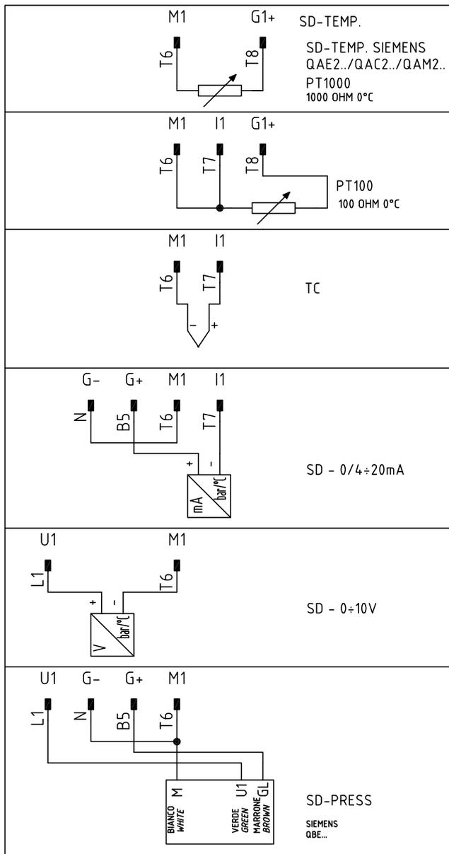
Рис. 13 - 7-х полюсный соединительный разъем для подсоединения датчиков
