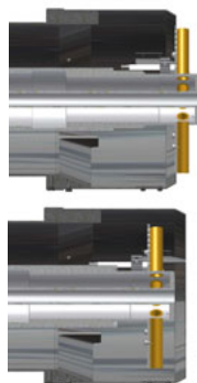
Положение головы сгорания “MIN” (мин.)
