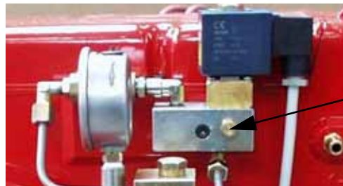
Рис. 19 - Распределительный блок дизтоплива (PG60)
