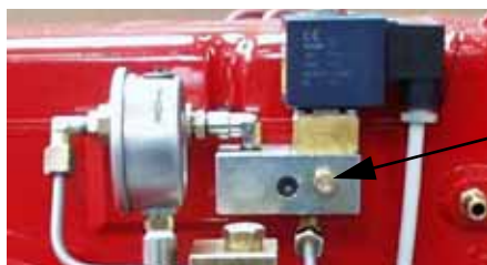
Рис. 15 - Распределительный блок дизтоплива (PG60)
