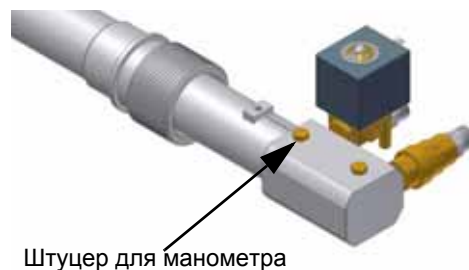
Рис. 16 - Голова сгорания с фурмой дизтоплива (PG70 - PG81)
