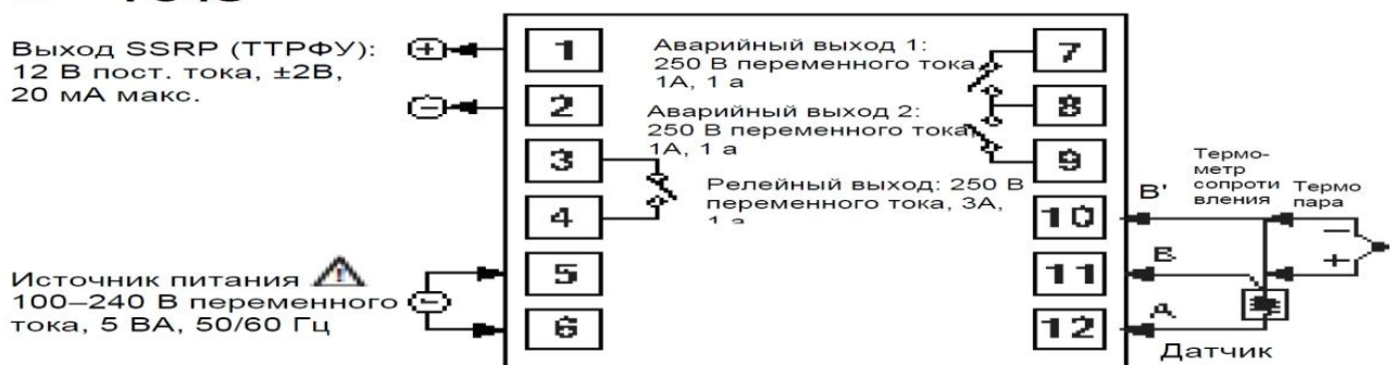
Рис. 9. Электрическая схема температурного контроллера.
