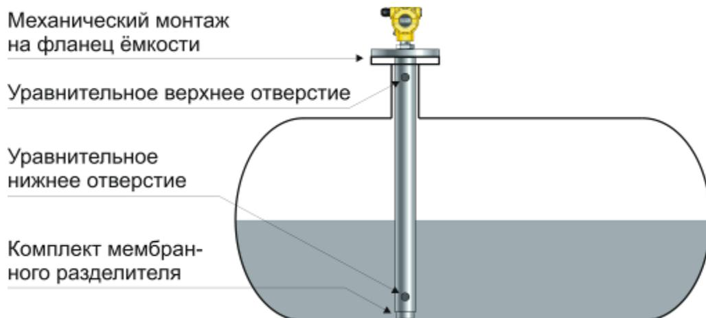
б) Пример монтажа уровнемера без защитной трубы.
