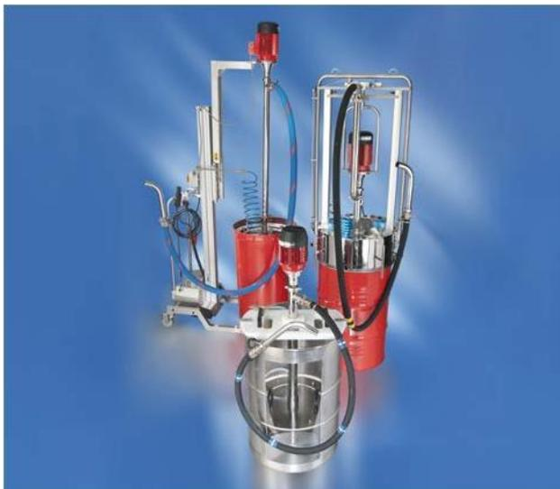
Системы для опорожнения бочек VISCOFLUX были специально разработаны для откачивания содержимого из бочек, содержащих материал с высокой вязкостью. Среды непрерывно и особо тщательно удаляются с помощью винтовых насосов. Все системы обеспечивают почти полное опорожнение бочек, при этом остаток составляет менее 1% (менее 2% для бочек с внутренней облицовкой).
