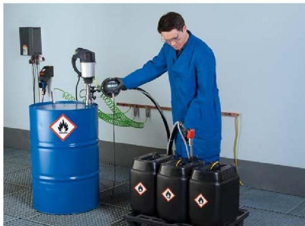
Полуавтоматическое наполнение резервуаров во взрывоопасной зоне 1.
