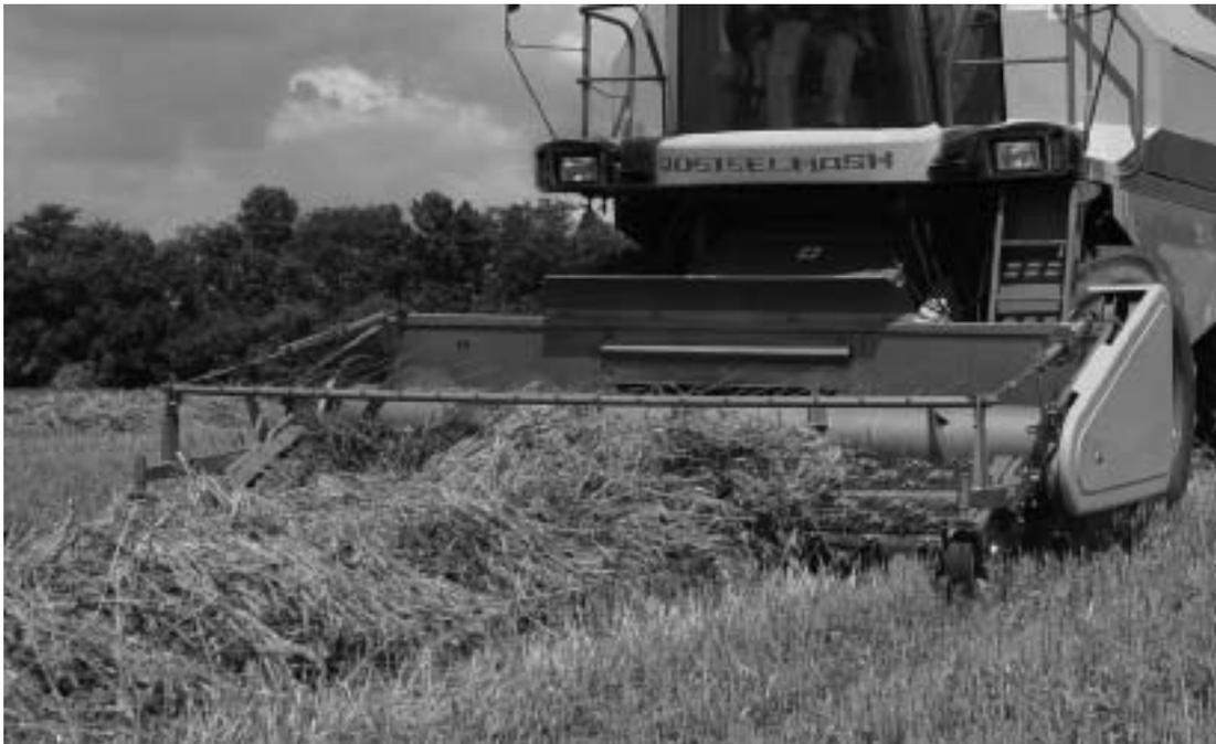
Рисунок 2.4 - Общий вид комбайна с платформой – подборщиком
