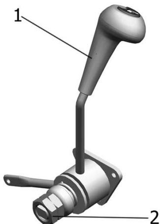
1 - рычаг; 2 – гайка регулировочная
