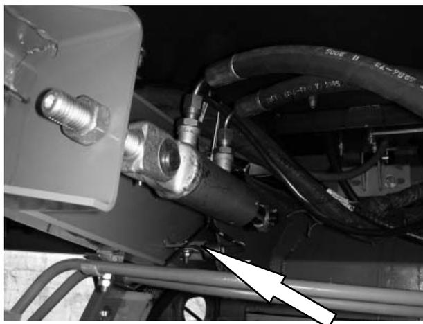
Датчик сигнализации включения наклонной камеры – с правой стороны комбайна
