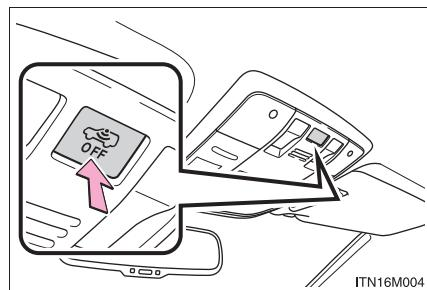
**■ Отключение и автоматическое повторное включение датчика вторжения и датчика наклона (при наличии)**
