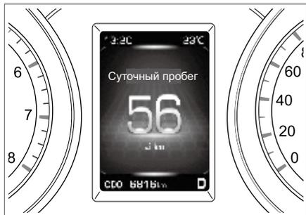
Можно записать пробег определенного отрезка движения.
