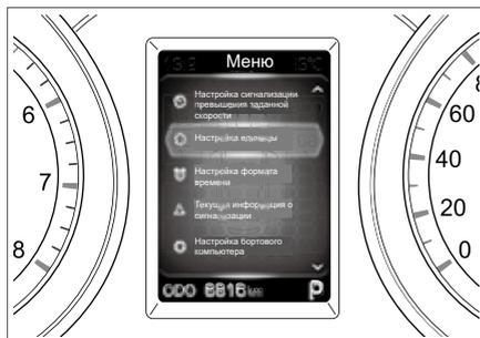
При любом отображаемом интерфейсе бортового компьютера кратковременное нажатие на регулировочное колесо на левом колесе позволяет войти в интерфейс настройки меню.
