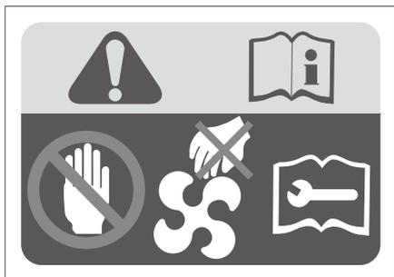
Данный ярлык расположен на внутренней декоративной панели двигателя и напоминает Вам «Вентилятор охлаждения может быть запущен в любое время, не протягивайте руки в защитный кожух вентилятора». В противном случае внезапный запуск вентилятора может вызвать серьезное телесное повреждение.
