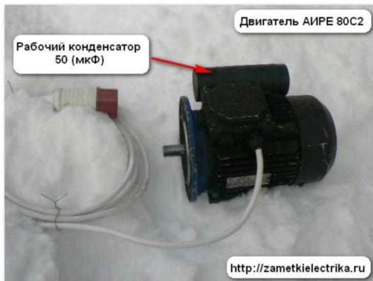
Если по условиям пуска однофазного двигателя требуется более высокий момент, то параллельно рабочему конденсатору на время пуска необходимо подключить пусковой конденсатор, емкость которого выбирают опытным путем для получения наибольшего пускового момента. По опыту можем сказать, что емкость пускового конденсатора можно взять в 2-3 раза больше рабочего.
