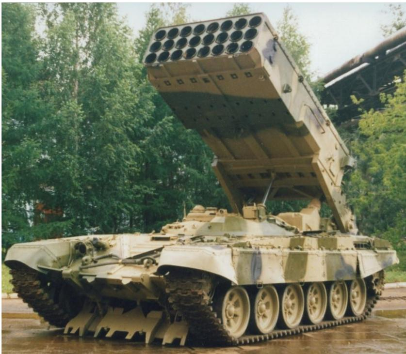
Стрельба производится **«с места»** без выхода экипажа из машины. Процесс наведения на цель и стрельба обеспечиваются автоматизированной системой управления огнем.
