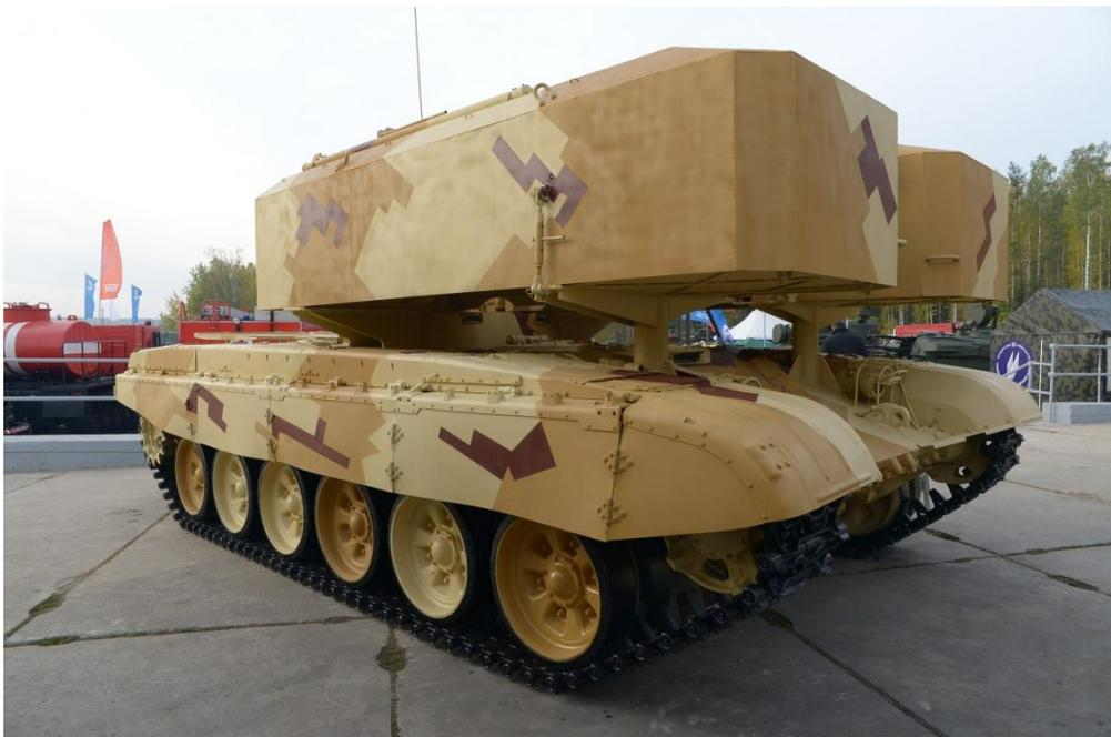
ТРАНСПОРТНО-ЗАРЯЖАЮЩАЯ МАШИНА ТЗМ-Т системы ТОС-1А предназначена для транспортирования боекомплекта НУРС, заряжания, разряжания боевой машины и при необходимости хранения боекомплекта.
