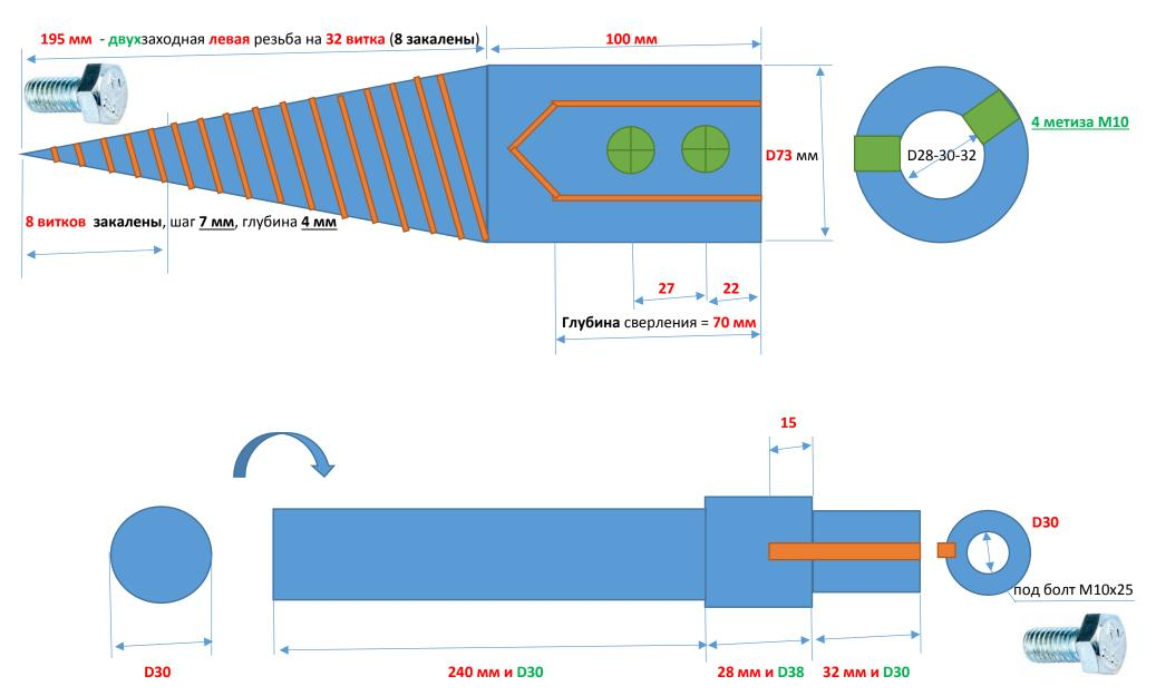
Под этот вал устанавливаются <u>два подшипника UCP 206</u>: внутр. <u>диаметр 30 мм</u>, высота от стола до центра вала <u>43 мм</u>, между отверстиями крепления <u>121 мм</u>. Шпонка **8х7 мм** (а в электродвигателях на валах D28,30,32 шпонка 10х8 мм). <u>От стола до центра конуса ДЕЛАТЬ 70 мм, а подконусный клин - съёмным</u>.
