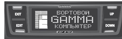
Бортовой маршрутный компьютер GAMMA GF270 (далее - БК) предназначен для контроля технического состояния и параметров движения автомобилей ВАЗ 2170 семейства "Лада - Приора".
