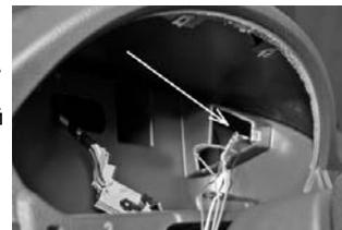
6. Подключить 9-и клеммную колодку к разъему БК и установить его вместо крышки вещевого отсека, предварительно вынув два резиновых демпфера.
