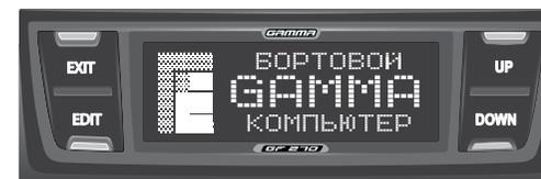
Бортовой маршрутный компьютер GAMMA GF270 (далее - БК) предназначен для контроля технического состояния и параметров движения автомобилей ВАЗ 2170 семейства "Лада - Приора".
