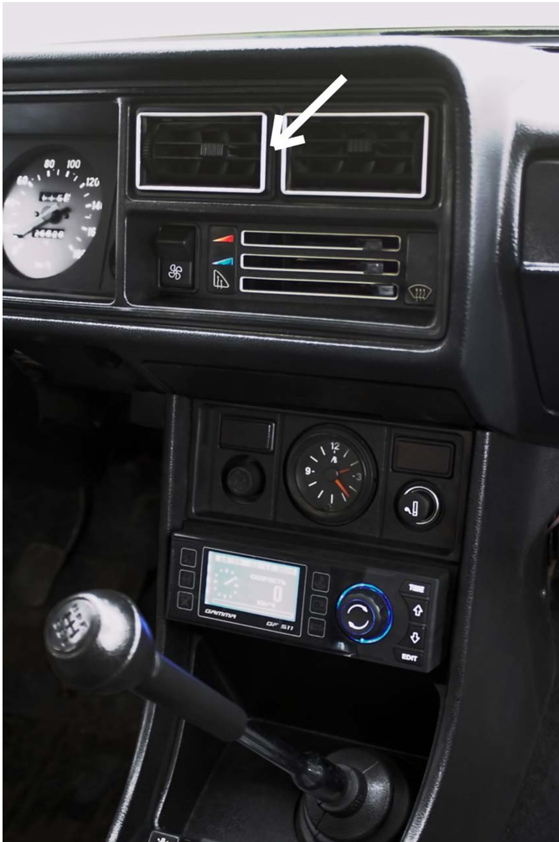
Рис. 2 БК в салоне ВАЗ 2107і (стрелкой указано альтернативное место установки)
