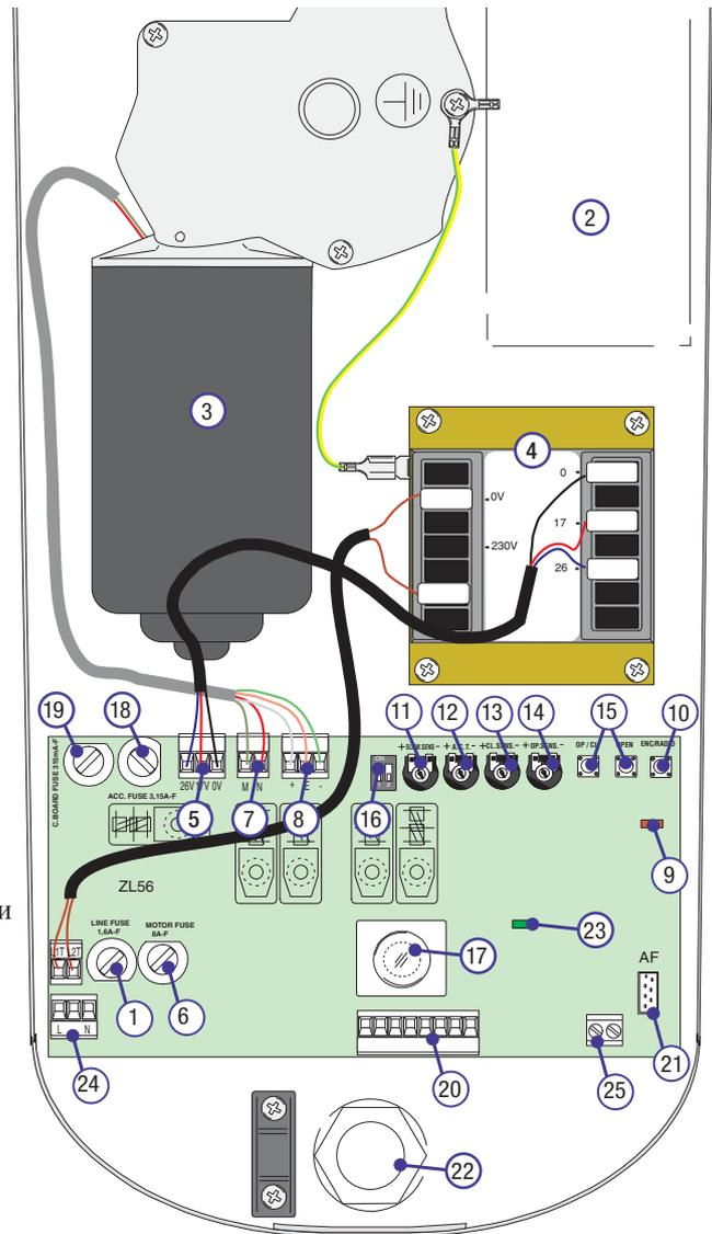
**⚠ ВНИМАНИЕ!** Перед проведением регулировок в блоке управления необходимо отключить электропитание и снять клеммы с аккумуляторов.
