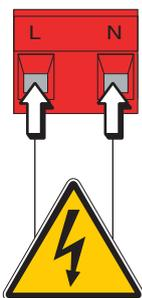
Вход для подключения электропитания ~220В, 50/60 Гц
