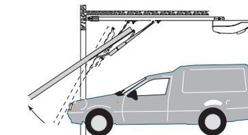
**⚠ ВНИМАНИЕ!** После трех последовательных циклов смены движения ворот функция "Автоматического закрывания" отключается, ворота остаются в открытом положении. Для закрытия ворот необходимо подать команду с кнопки или брелка-передатчика.
