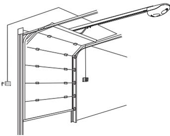
Кнопка "СТОП" (контакты НЗ) - кнопка остановки ворот. Автоматическое закрывание отключается. Для возобновления движения подать команду с кнопки управления или брелка-передатчика.
