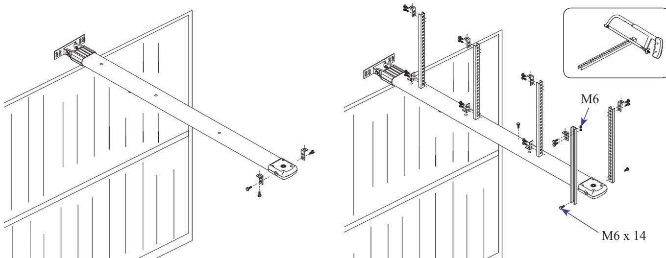
3) Закрепите направляющий профиль к потолку, используя соответствующие болты.
