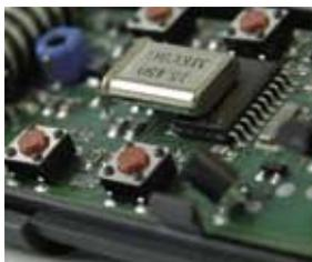
Кодирование с помощью кабеля. Модели T432, T434 и T438 могут быть подсоединены к приемнику RBE4N с помощью кабеля. Это облегчит процедуру кодирования в том случае, если необходимо создать несколько передатчиков с одинаковым кодом для использования на промышленных объектах и в многоквартирных жилых домах.
