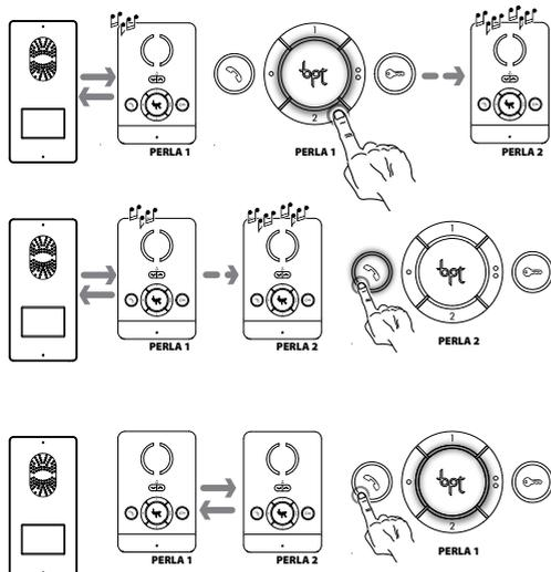
Если связь активна, выберите номер устройства для переадресации вызова; нажмите клавишу **☎** на принимающем абонентском устройстве.
