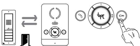
Отображение открытия замка двери на вызывной панели
