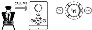
В случае отсутствия ответа пользователя на вызов консьержа светодиод AUX2 продолжает светиться до тех пор, пока пользователь не перезвонит консьержу.
