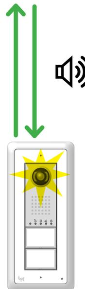
**RU** Для ответа на вызов и активации аудио связи с вызывающим пользователем нажмите клавишу "ответ" или клавишу вызываемой линии.
