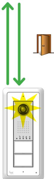
**RU** При активном подключении к вызывной панели (с аудио\видео или аудио) нажатие клавиши
