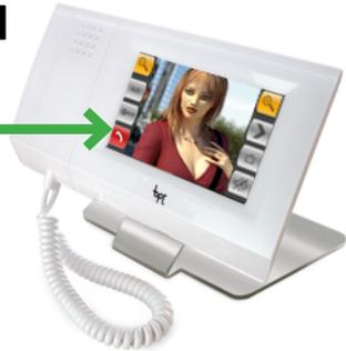
**RU** При нажатии
