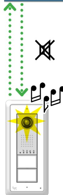
**RU** При активном вызове (рис. 1), нажмите клавишу активной линии, чтобы перевести вызов в режим ожидания (рис. 2), вызывающий (у абонентского устройства или вызывной панели) услышит мелодию. Для возобновления сигнала нажмите клавишу линии связи снова.
