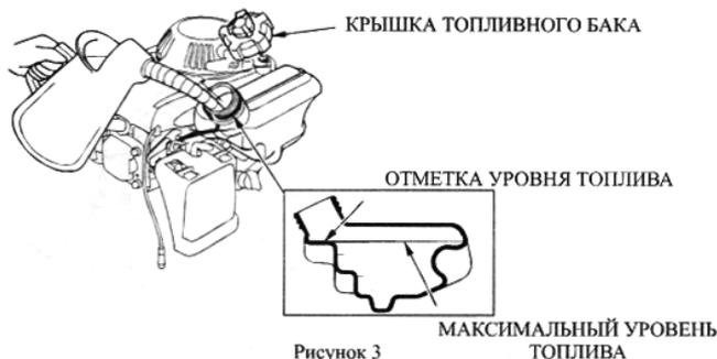
Заливайте топливо до нужной отметки на топливном баке. Не переполняйте бак. Вытрите пролившееся топливо.
