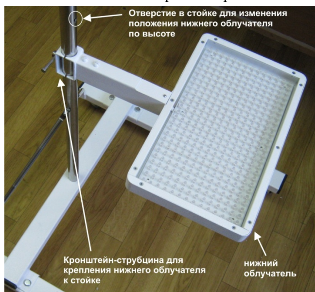
Рис.4. Крепление нижнего облучателя к стойке аппарата.
