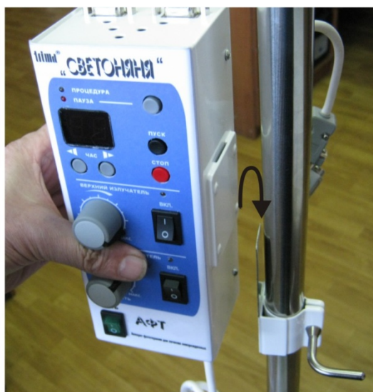
Рис.7. Элементы установки и фиксации электронного блока на мобильной стойке.
