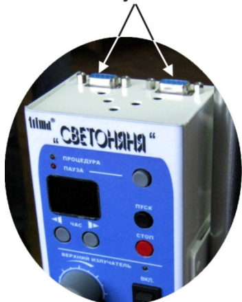
Рис.6. Расположение разъёмов для подключения кабелей питания облучателей на верхней панели электронного блока.
