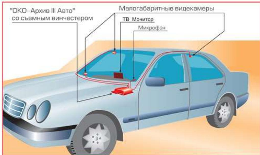
Контроллер-квадратер с 4 камер на 1 монитор
