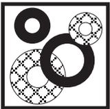
После проведения разборки или изменения конструкции уплотнители следует заменять новыми.
