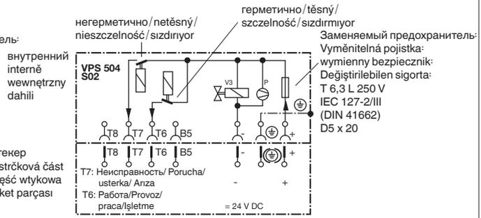
**Электрическое соединение VPS 504 S03**
