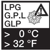
В газоидностных системах не эксплуатировать VDK 200 A ниже 0 °C. Подходит только для газообразного сжиженного газа, жидкие углеводорода нарушают уплотнительные материалы.
