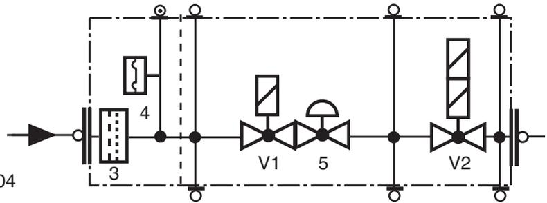
Possibile montaggio del controllo valvole VPS 504
