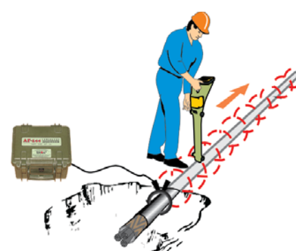
Подключение с помощью индукционных клещей
