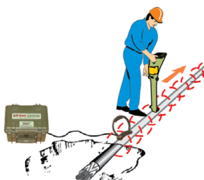
Подключение через антенну рамочную ИЭМ-301.1
