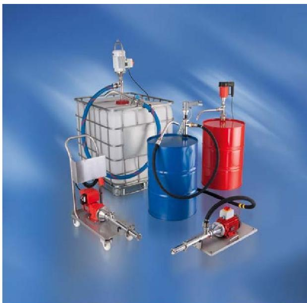
Винтовые насосы FLUX сделаны для перекачки вязких сред. Объёмные насосы работают с низкой турбулентностью при постоянном давлении и обеспечивают плавную и безимпульсную работу. В то время, как насосы серии F 550 используются в промышленном секторе, насосы серии F 560 специально спроектированы для фарм., пищевой и косметической отраслей. Насосы могут применяться как мобильно, так и стационарно. Они состоят из небольшого числа компонентов и легко поддаются разборке.
