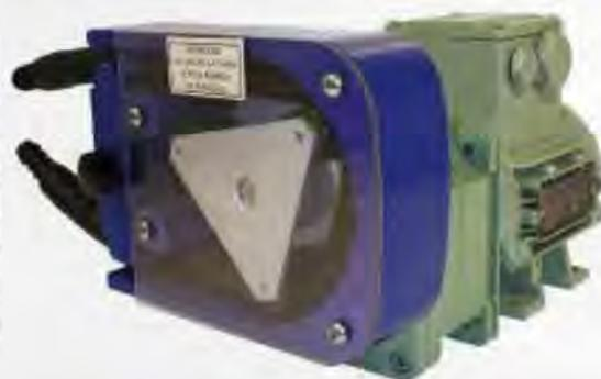
Le parti meccaniche sono lavorate al tornio per ottenere un'alta precisione e tarate singolarmente durante il montaggio ed il successivo collaudo per distribuire una pressione uniforme sul tubo-membrana, garantendo così un perfetto auto-adesamento ed una maggiore durata del tubo.
