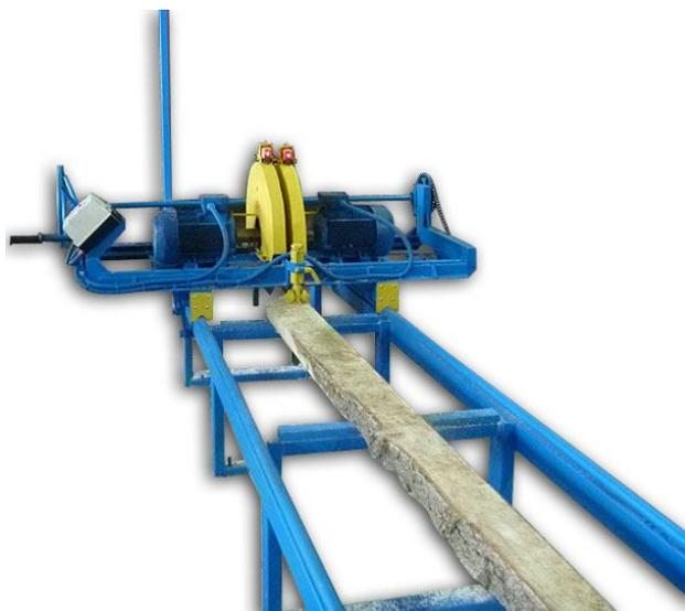
2x5,5 кВт, высота пропила до 80мм, 2 пилы по 450мм
