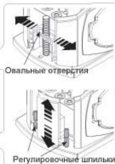
По окончании регулировки установить на шайбы и затянуть крепежные гайки. Одеть и закрепить пластиковую крышку.
