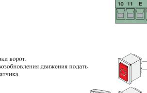
Кнопка "СТОП" (контакты Н3) - кнопка остановки ворот. Автоматическое закрывание отключается. Для возобновления движения подать команду с кнопки управления или брелка-передатчика.
