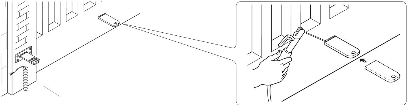
**ПРИМЕЧАНИЕ:** если створки неметаллические, соберите и сварите две части переднего кронштейна и закрепите на створке ворот болтами.
