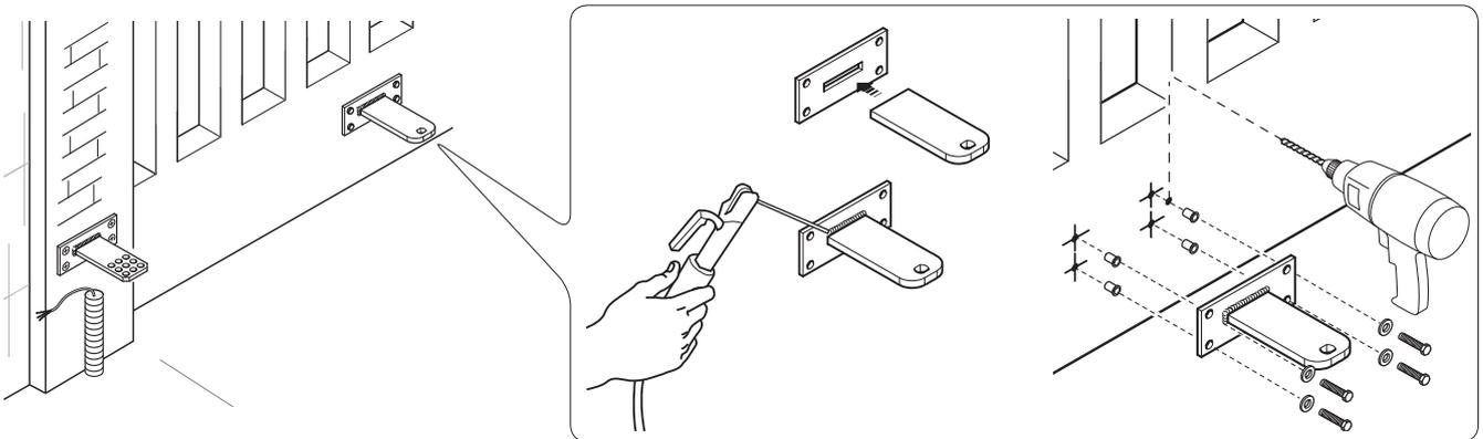
Смажьте и установите втулку в отверстие заднего кронштейна. Кронштейн имеет несколько отверстий, которые позволяют регулировать угол открывания. Закрепите хвостовик привода к заднему кронштейну.
