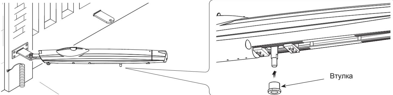
Сдвиньте створку ворот до совмещения отверстия на переднем кронштейне со штоком привода (рис. 1). Или разблокируйте привод (см. раздел "Разблокировка привода"), снимите переднюю крышку и передвиньте шток с помощью отвёртки (рис. 2). Закрепите привод на переднем кронштейне с помощью прилагаемой гайки с шайбой.
