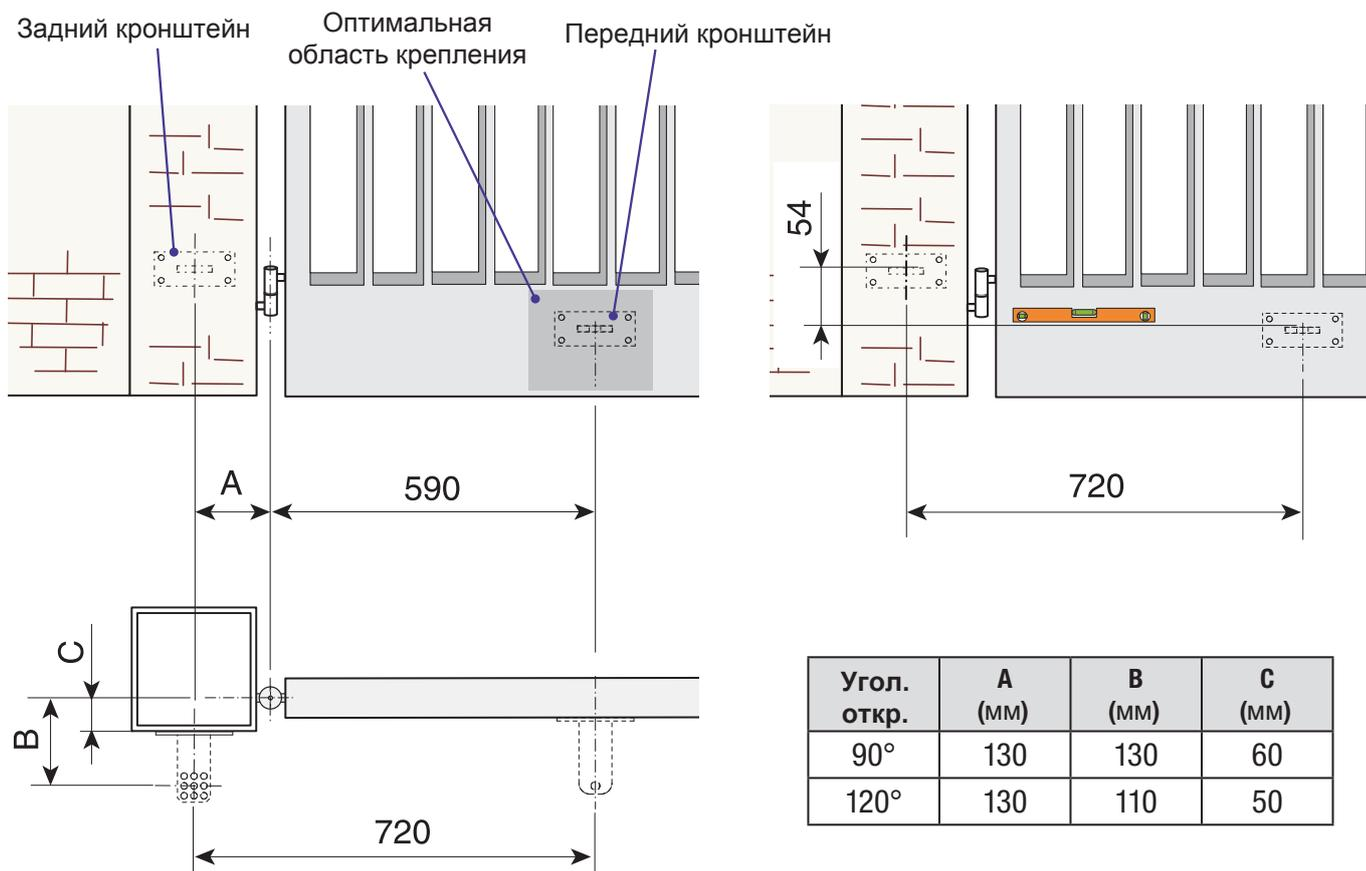
При помощи сварки соедините две части заднего кронштейна. Закрепите кронштейн на столбе выбранным способом: дюбелями с винтами или, если столб металлический, с помощью сварки.
