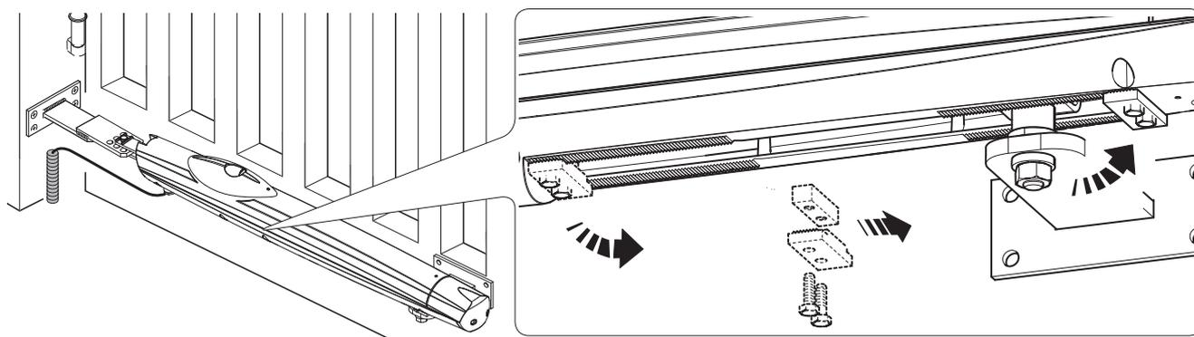
Полностью откройте створку. Ослабьте гайки крепления механического упора и установите его вплотную к штоку. Затяните гайки.
