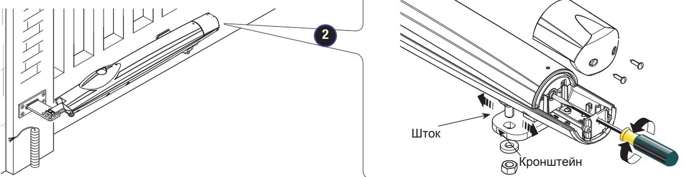
Полностью откройте створку. Ослабьте гайки крепления механического упора на приводе и установите его вплотную к штоку. Затяните гайки.
